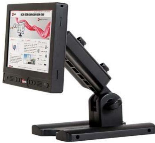
Die 7-10" Touch-Monitorserie von faytech setzt neue Standards: HDMI-Anschluss, drei Video-Eingänge, erweiterter Stromeingang (12-36V), extra robuste Komponenten, exklusives Design, einbaufähig, Backlight-LED, garantiert pixelfehlerfrei, hochwertiger Standfuß, erweiterter Temperaturbereich und für den 24/7-Betrieb geeignet sind nur einige der Features, die diese Monitore erfüllen.
